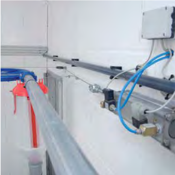
Mecanismo automático de desbloqueo para dosificador volumétrico
