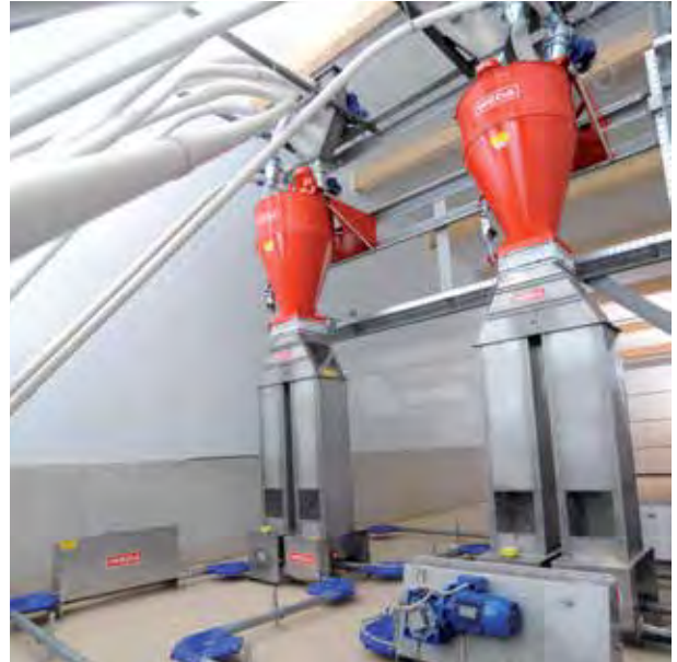
Sistema DryComp (funcionamiento en paralelo)
