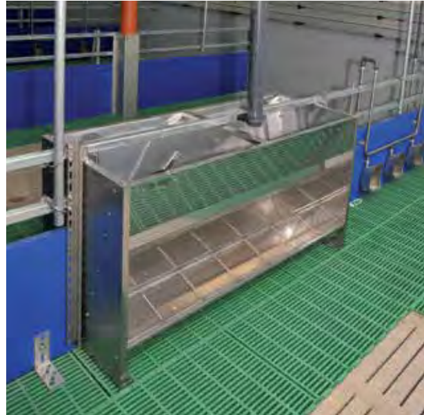
Alimentador doble automático de alimento seco de acero inoxidable con 2x7 alimentadores
